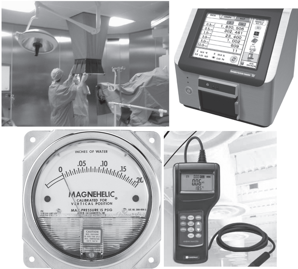
รูปที่ 2 ตัวอย่างเครื่องมือวัดปริมาณลม (บนซ้าย) เครื่องวัดปริมาณอนุภาคฝุ่นในอากาศ (บนขวา) เครื่องวัดแรงดันตกคร่อม (ล่างซ้าย) เครื่องวัดความเร็วลม (ล่างขวา)
